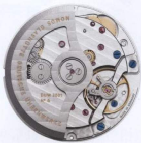
NOMOS Glashütte DUW 3001自动上链机芯 直径12¾法分 / 厚度3.2毫米 / 27石 / 自制独味搭载蓝色游丝 / 双向自动上链 / 储能42小时
